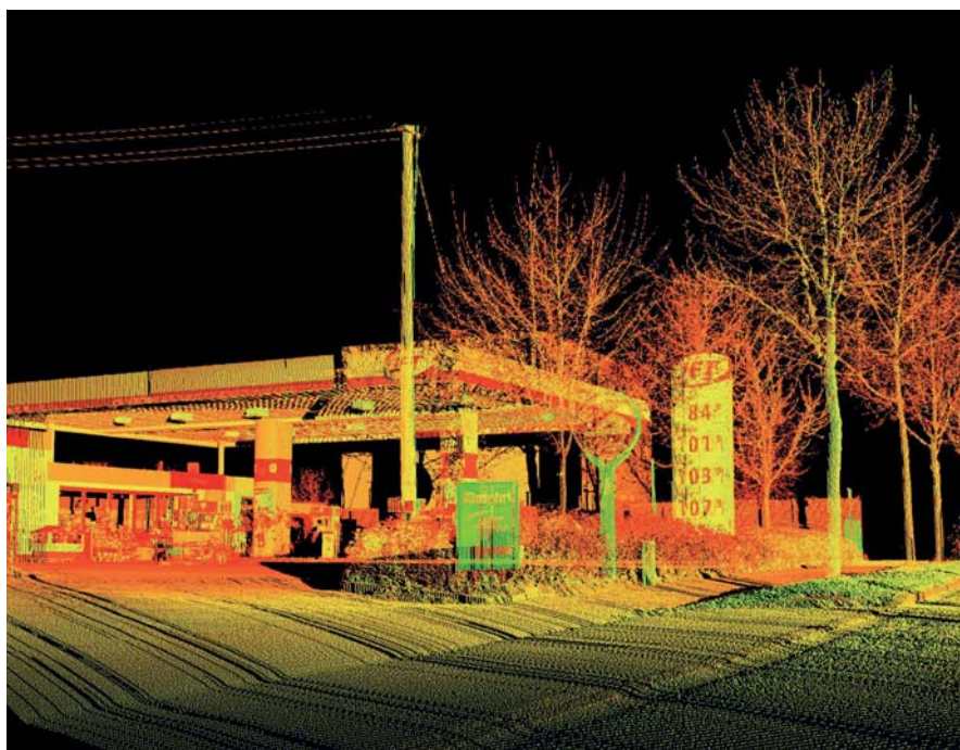
JET-Station Bodenseestraße in München, auch neuen Meßmethoden räumen wir Freiraum ein: eine Tankstelle mit dem 3D-Laserscanner erfasst
